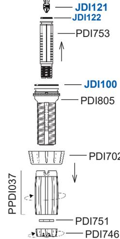
**!** Para remover fácilmente el O-ring sin uso de herramientas, simplemente apriete ambos lados del o-ring y este levantará una parte para poder ser extraído.
